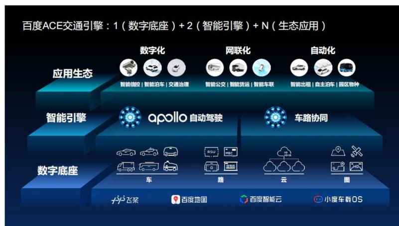
图 3：百度 ACE 交通引擎总体架构
